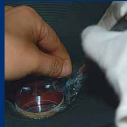
Fissaggio bobina mobile/cestello su un trasduttore delle basse da 10" (254mm.).
