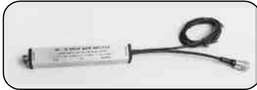
In alcuni casi è necessario amplificare i segnali in antenna nelle gamme delle onde lunghe, medie e corte. Ad esempio quando il ricevitore non è abbastanza sensibile, ma specialmente quando viene usata un'antenna a bassa efficienza.
