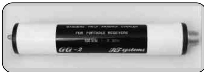
Noterete eccezionali miglioramenti in ricezione anche a distanze di 30 cm. tra l'AA-2 ed il ricevitore. In caso di estremo sovraccarico, o magari anche solo per regolare il livello di segnale adeguatamente a seconda delle condizioni in modo più flessibile, si potrà collegare l'AA-2 al ricevitore tramite l'AA-1, ed agire sul potenziometro di quest'ultimo.
