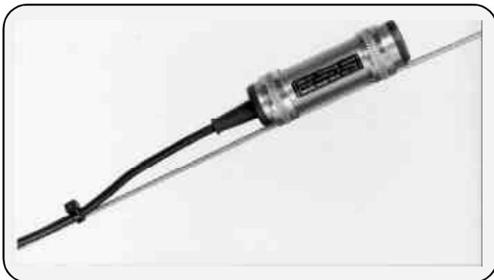
E' pertanto stata sviluppata, per risolvere questi problemi, una speciale versione MARINA, racchiusa in un cilindro d'acciaio inossidabile lungo 8 cm. e con diametro di 22 mm. Questo è stato riempito con resine epossidiche al fine di garantire che tutti i componenti interni siano pienamente protetti contro le vibrazioni, gli urti ed i movimenti del cavo.
