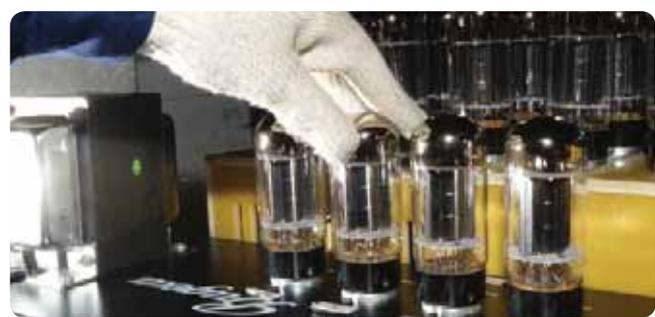
Al termine del collaudo, i set di valvole prescelti vengono sottoposti a burn-in e polarizzati.
